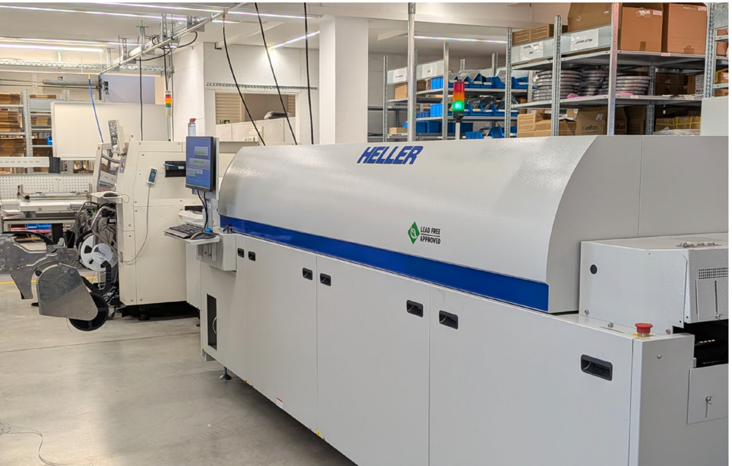
Der Reflow-Ofen schmilzt die Lötpaste und erzeugt stabile SMD-Lötverbindungen.
